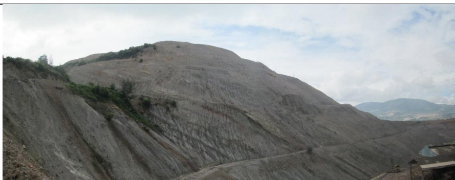
Fotografía Sociedad Ladrillera Zigurat S.A.S. Se aprecia los taludes y bermas temporales del Frente Sur donde realizan actividades de explotación de minerales
